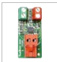
CARTE INTERFACE BUS Pour branchement cellules photoélectriques traditionnelles.
